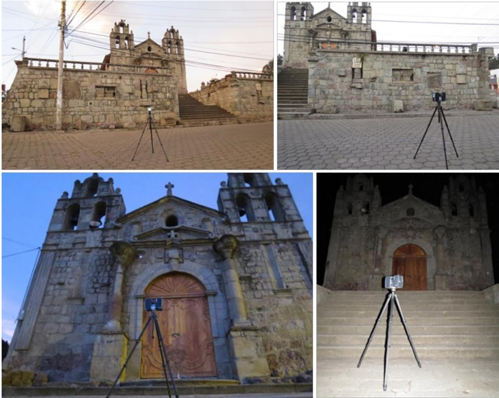
Figura 93. Ficha de campo, replanteo (ubicación de esferas y toma de imágenes) según parámetros de configuración descritos
