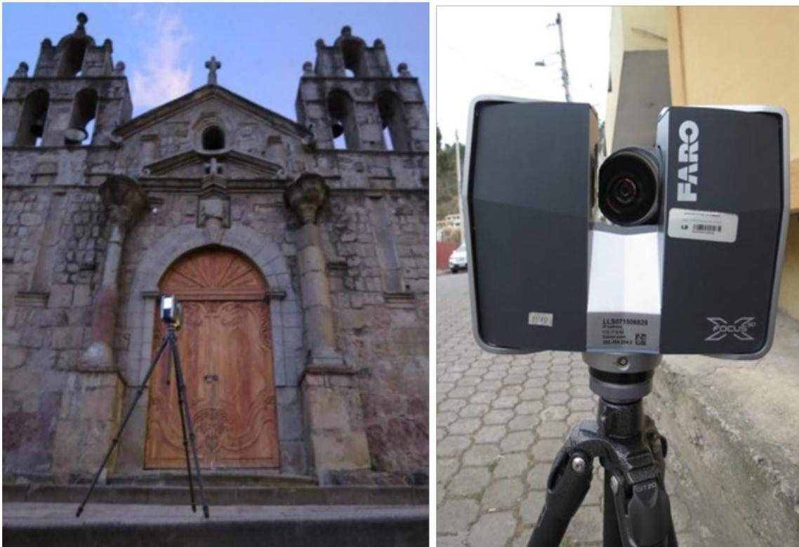
*Nota: en el proceso de levantamiento e información, se observa la fachada de la iglesia Nuestra Señora de las Nieves de Sicalpa Viejo y equipo escáner FARO Focus Láser 3D.*
