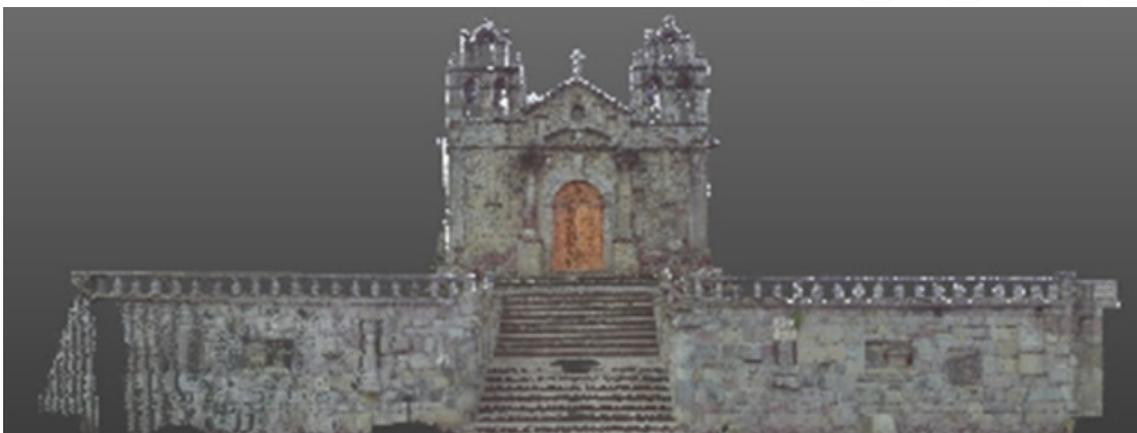
*Nota: Nube de puntos de las portadas de la Iglesia Sicalpa Viejo, levantada con escáner FARO Focus Láser 3D y depurada con programa software Trimble Real Works.*
