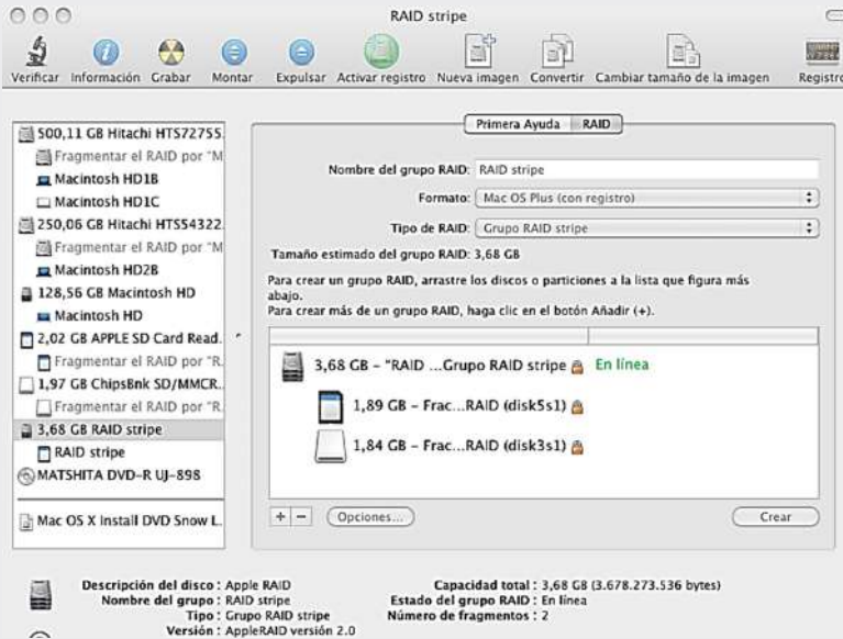
Fig. 3.114. Creación del Grupo RAID stripe
