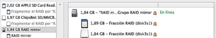
Fig. 3.108. Crea el conjunto RAID que aparecerá con el nombre que le hemos asignados
