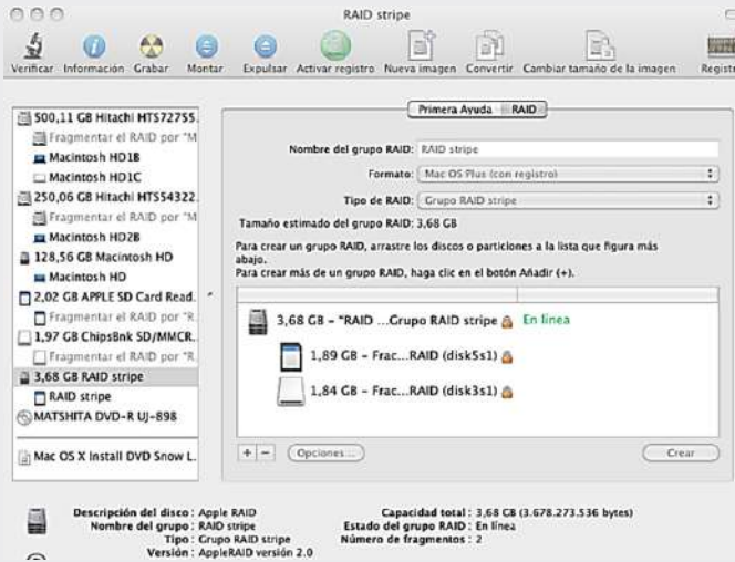
Fig. 3.100. Creación del Grupo RAID stripe
